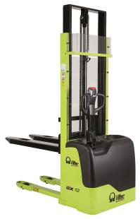
Este apilador de tamaño compacto es la solución ideal para trabajar en espacios reducidos y tiene un aspecto potente y fiable. El ancho reducido(800 mm), el sistema de conducción lateral y el amplio posicionamiento del mástil permiten una gran maniobrabilidad, estabilidad y visibilidad. El cargador de batería incorporado con cable y enchufe integrados lo convierte en una máquinaplug and play!
