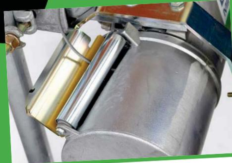
El motor se para cuando el cable se afloja; el cable permanece tenso en el tambor para evitar nudos
