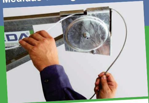
Fácil posicionamiento del cable de acero por las poleas de los brazo polea sin desmontar nada
